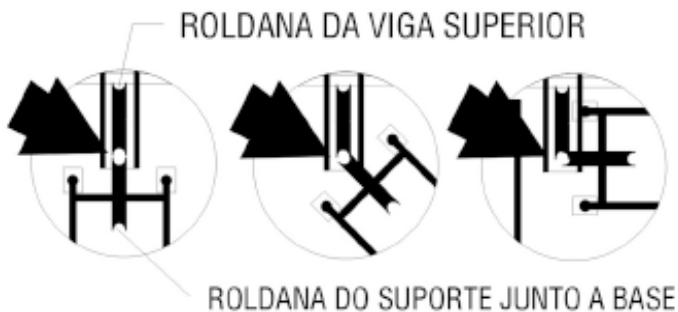
Figura 6 Opções para diversas posições de montagens do guincho
